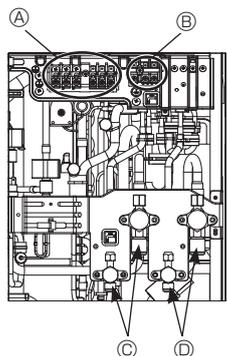
Ⓐ TRABAJO DE CABLEADO: Conectar a corriente y unidad interior
