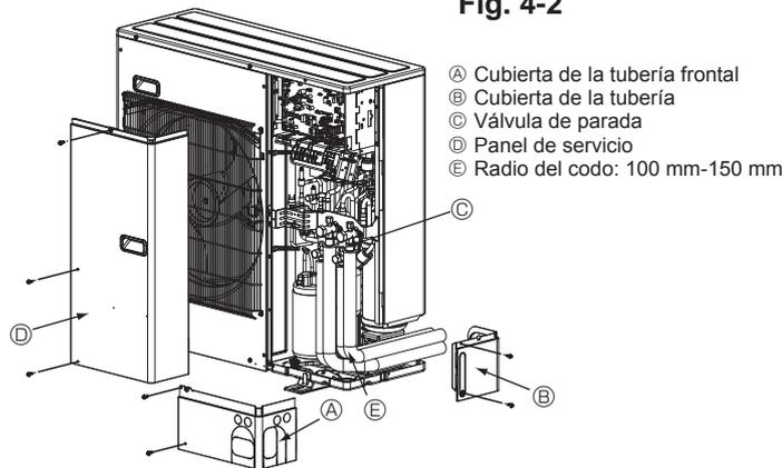
Ⓐ Cubierta de la tubería frontal
